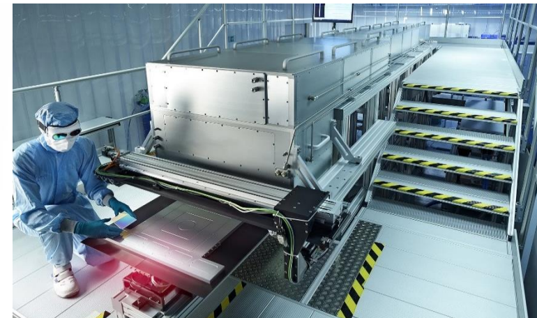
固体激光剥离紫外激光线光斑系统
